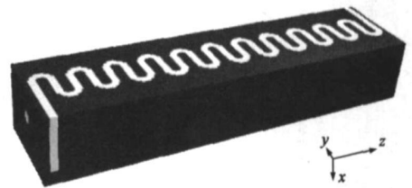
图 4 十一个周期折叠波导慢波电路三维相互作用几何模型
